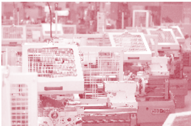
Un tour sécurisé conçu par le Centre de production automatisée.
